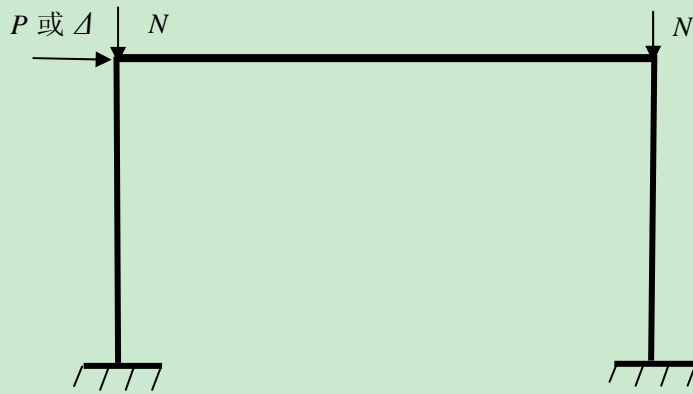
图 4.1 组合框架加载及边界条件简图
